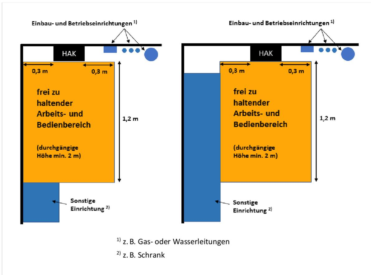
Abbildung 2 - Abmessungen des frei zu haltenden Arbeits- und Bedienbereichs vor dem HAK
