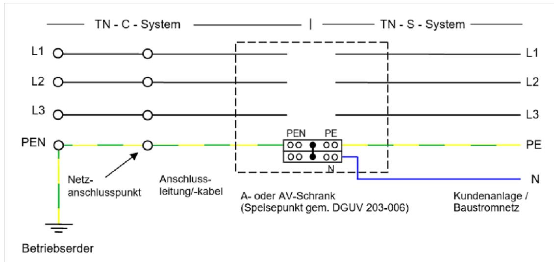
Abbildung 7 - Anschlussmöglichkeiten am Beispiel des TN-C-Systems
