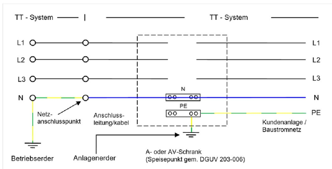
Abbildung 8 - Anschlussmöglichkeiten am Beispiel des TT-Systems
